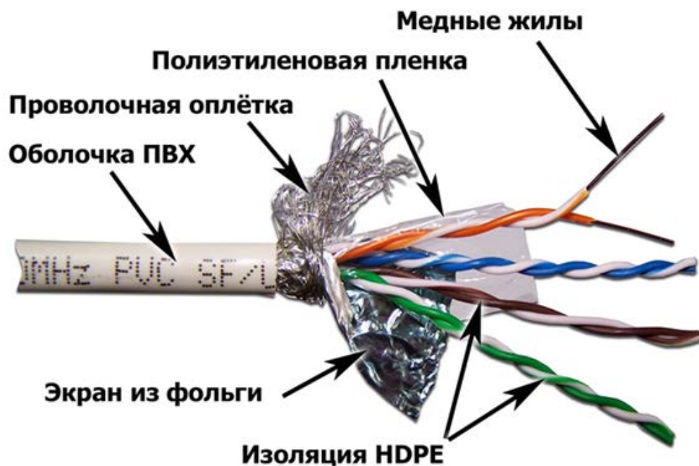
Рисунок 1.3 – Структура витой пары STP
